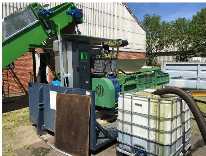
Figur 1. Venstre foto viser Twin Screw i forsøget med presning af friskhøstet græs. Fotoet til højre viser fiberfraktionen efter presning.
