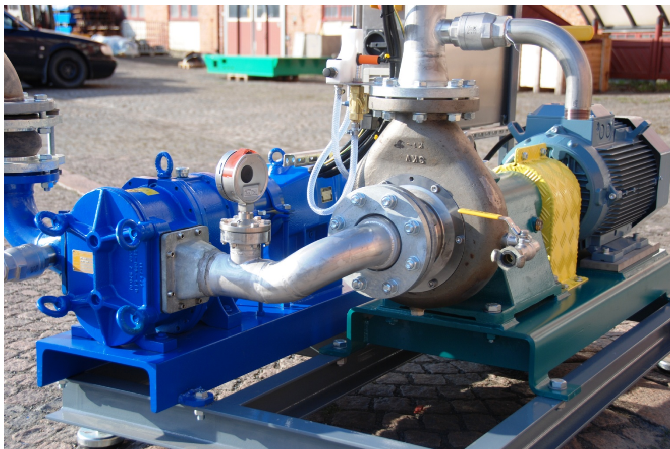
Grubbens Deflaker med fødepumpe
