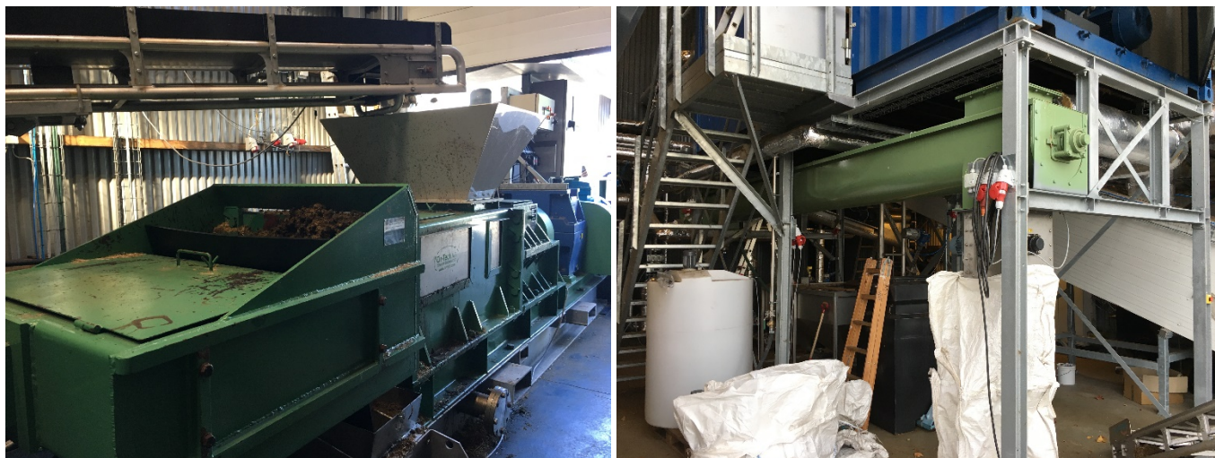
Figur 2. Venstre foto viser Twin Screw, hvor fiberfraktionen fra Börger skruepressen føres ind ovenfra via transportbåndet. Højre foto viser udsnit af AST tørringsanlægget, hvor fiberfraktionen kan tørres til ønsket niveau. Den tørrede fiber afleveres under det grønne rør.
