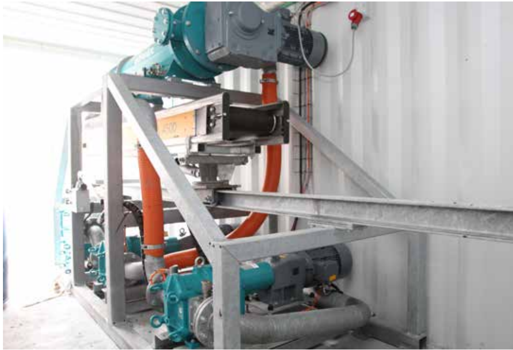
SEPARATOR: Selve gjødselseparatoren sitter på toppen. Nederst sitter det to pumper som pumper henholdsvis inn og ut
