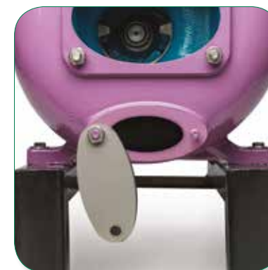
Rense dækslet bruges til at tømme pumpehuset, især i de koldere måneder, og forhindre væsken i at fryse i pumpen
