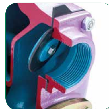
Kontraventil forhindrer tilbageløb af væske i afgangsledningen. Tilgængelig i NBR, FKM, PTFE og EPDM
