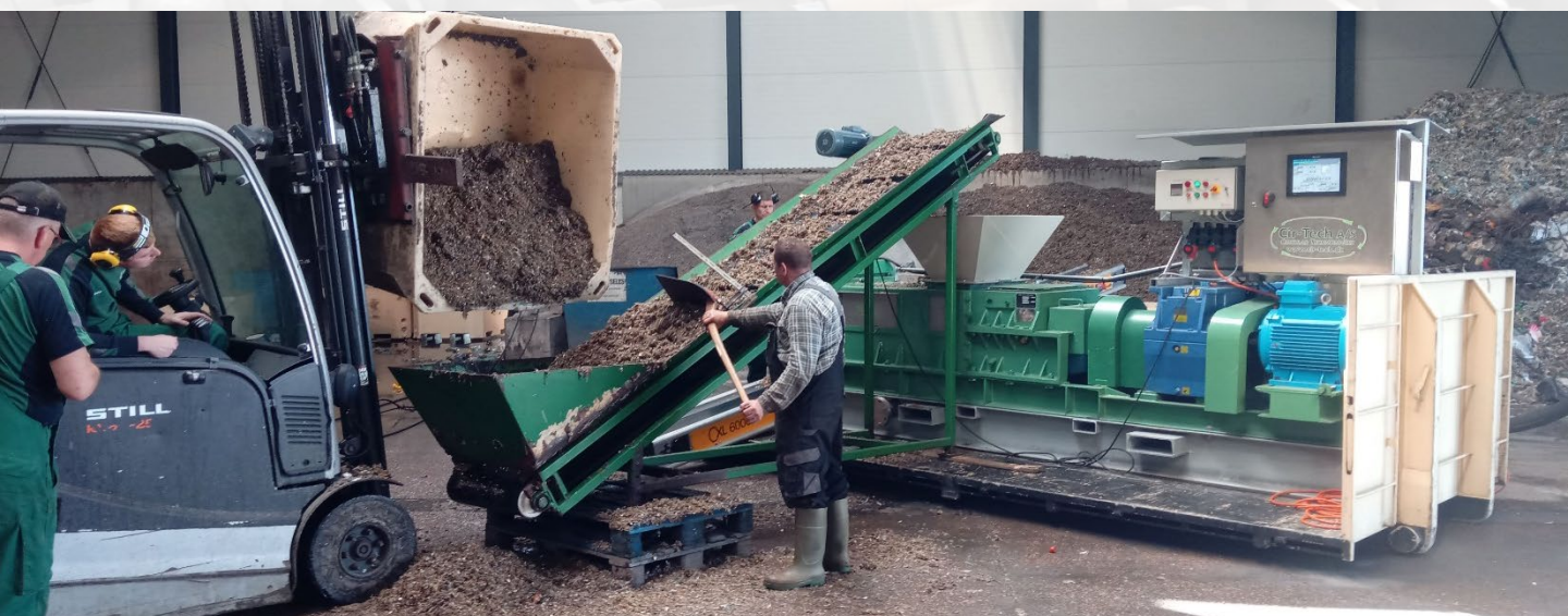
Flytbart testanlæg, gør det muligt at teste effektiviteten af Twin Pressen hos kunderne
