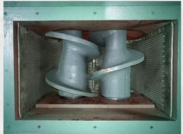
Der Einlauf ist mit einem kräftigen Sieb ausgestattet damit freie Flüssigkeit schnell ablaufen kann. Die große Steigung der Schraubenwindungen sichert eine gute Füllung der Schnecken.
