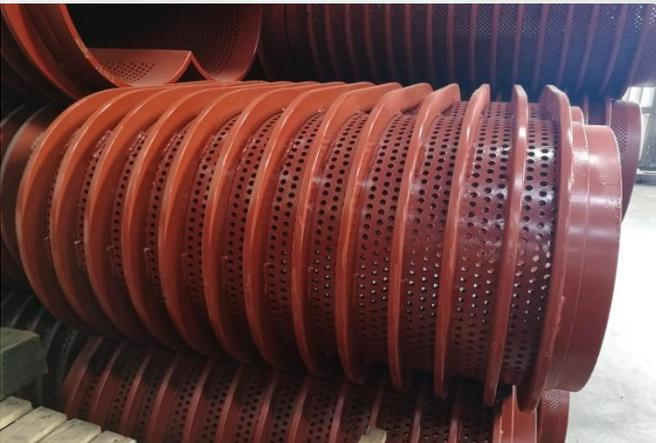
Die runden Löcher im Filter sind konisch, so dass das Material die Löcher nicht zustopfen kann. Die Filter gibt es in 3 oder 4 mm Öffnungen als Standard.
