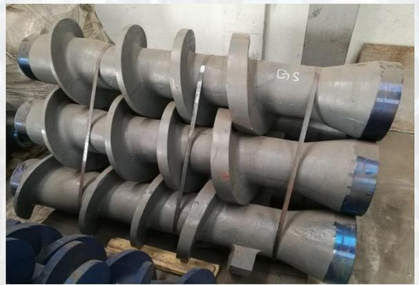
Die sehr kräftige Bauart und Ausführung der Schrauben verhilft zu einer schnellen Weiterführung vom Material im Eingangsbereich und der immer kleiner werdende Platz zwischen den Schneckenwinden, ergibt einen hohen Press in den Presszonen. Dies sichert einen sehr hohen Grad von Pressung. Die Schrauben können bei Slitage aufgeschweisst werden.
