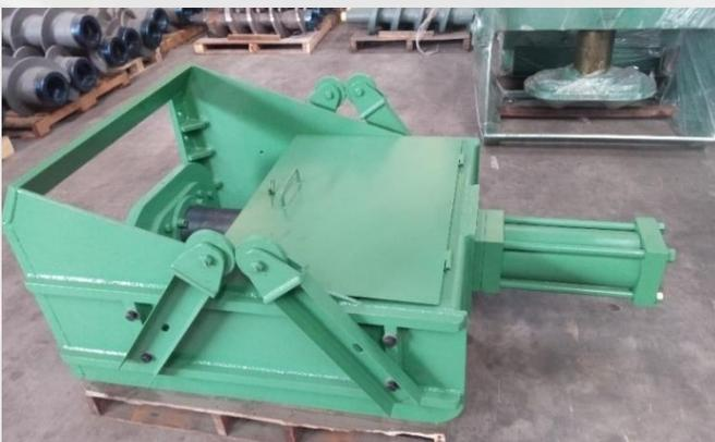
Der hydraulische Gegendruck kann zum Service leicht abmontiert werden.
