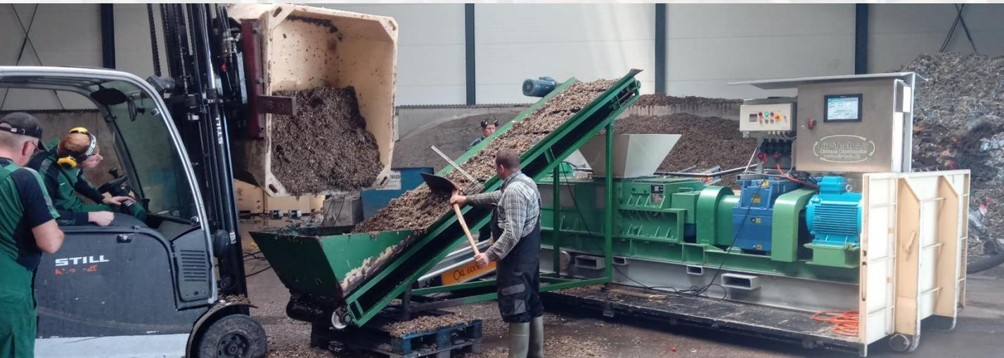
Die Twin Presse Testanlage kann direkt beim Kunden aufgebaut werden um ihre Effektivität zu testen.
